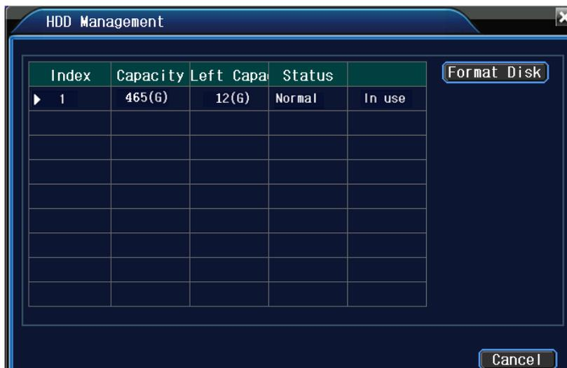
Formater : Permet de formater le disque dur sélectionné.
