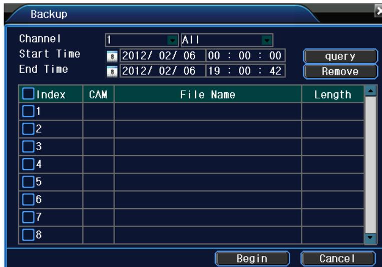
Type : Permet de sélectionner le type d'événement à sauvegarder sur le support amovible. Par défaut Tous. Caméra : Permet de sélectionner les caméras dont vous voulez extraire la sauvegarde.
