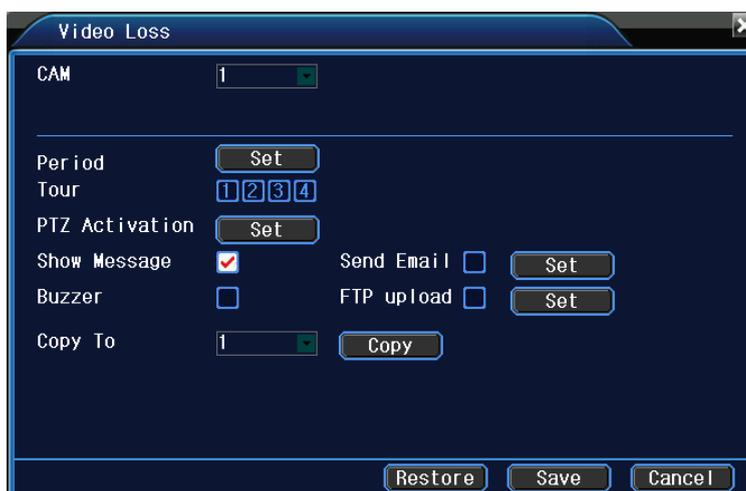
Caméra : Permet de sélectionner la caméra à configurer.
