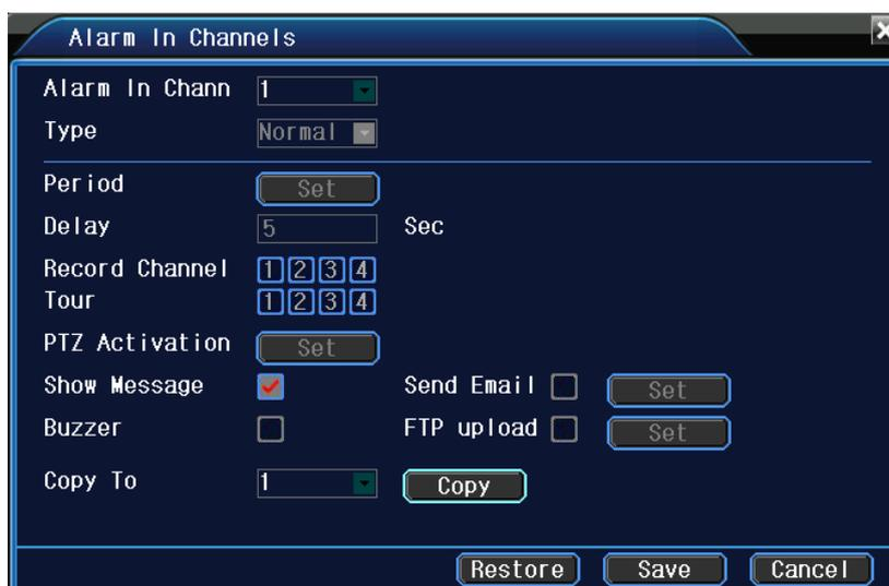
Enregistrement : Permet de sélectionner le nombre de caméras lançant un enregistrement lors d'une détection de mouvement.
